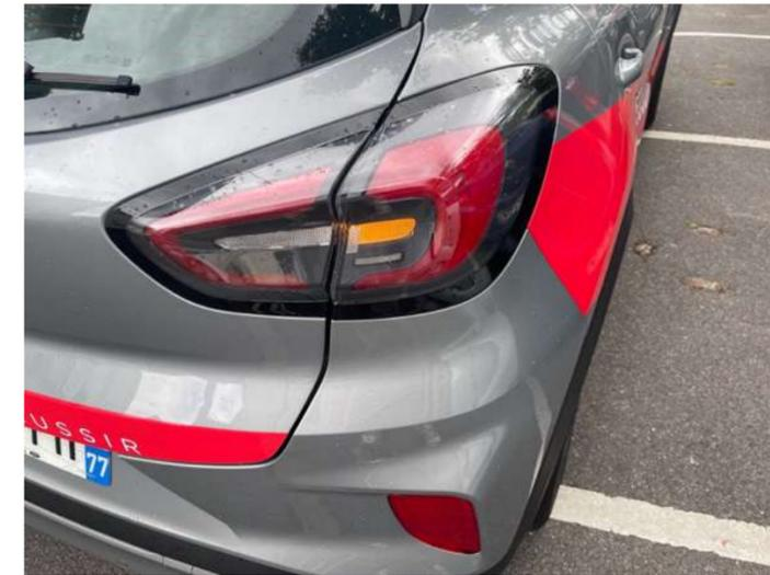
**Vérification des clignotants propres, en bon état de fonctionnement et pas cassés (toute anomalie et dysfonctionnement doit être signalé).**
