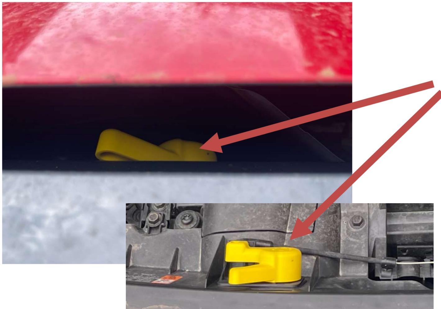
Une fois face au véhicule, un second verrou se situe sous le capot. Tirer la seconde languette vers la gauche pour déverrouiller le levier.
