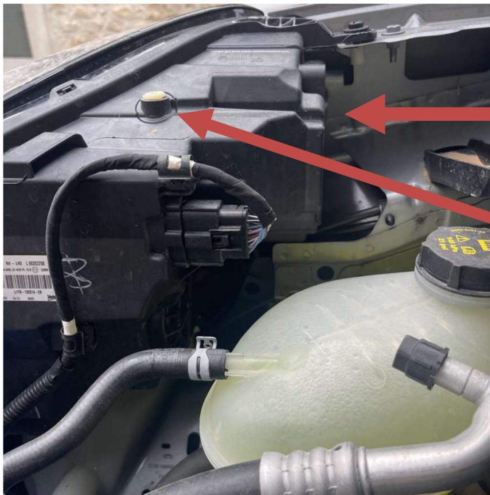
**Changement d'une ampoule par l'arrière du bloc optique**
