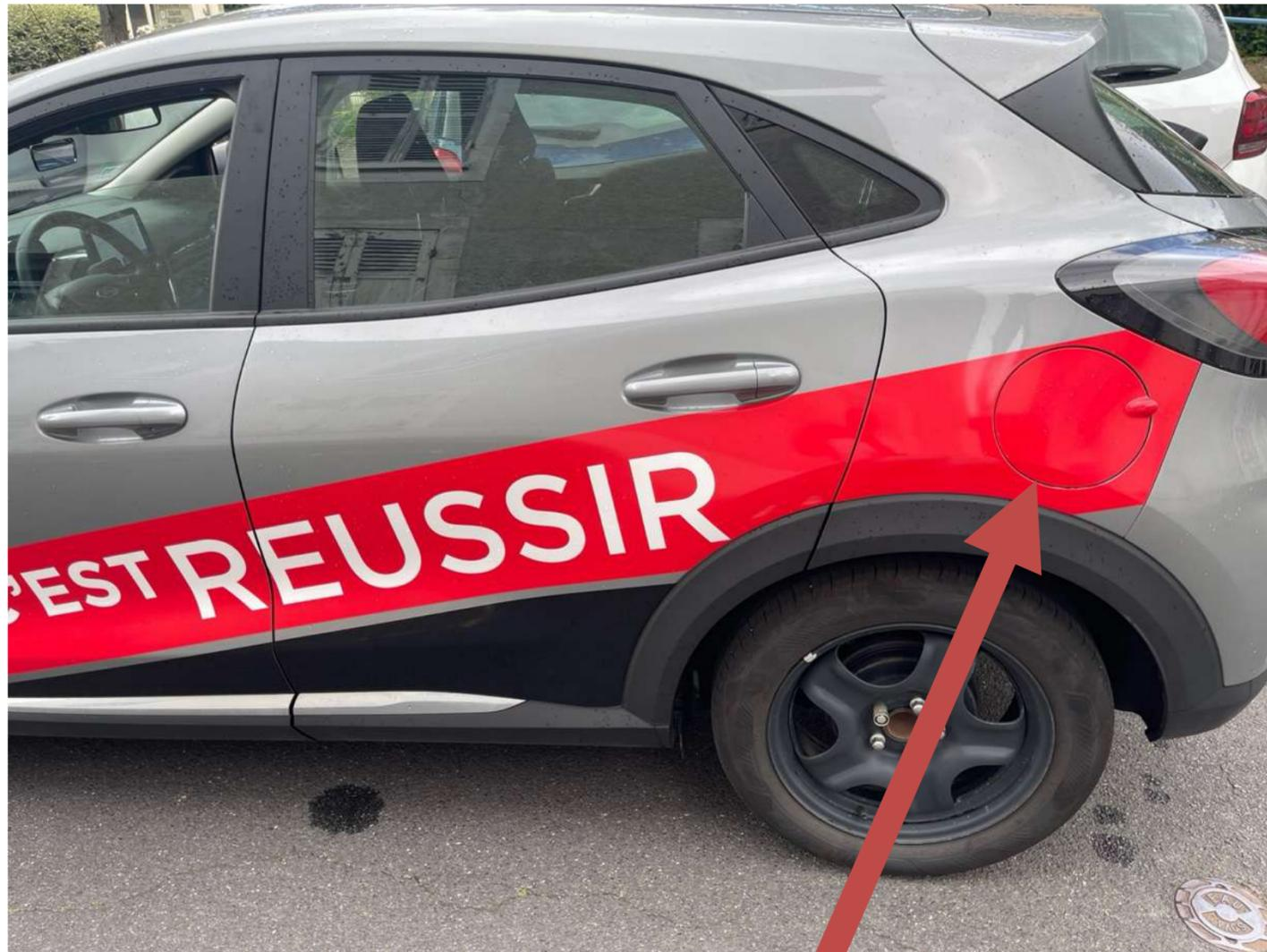
**Ouvrez la trappe à carburant et/ou vérifiez la bonne fermeture du bouchon.**
