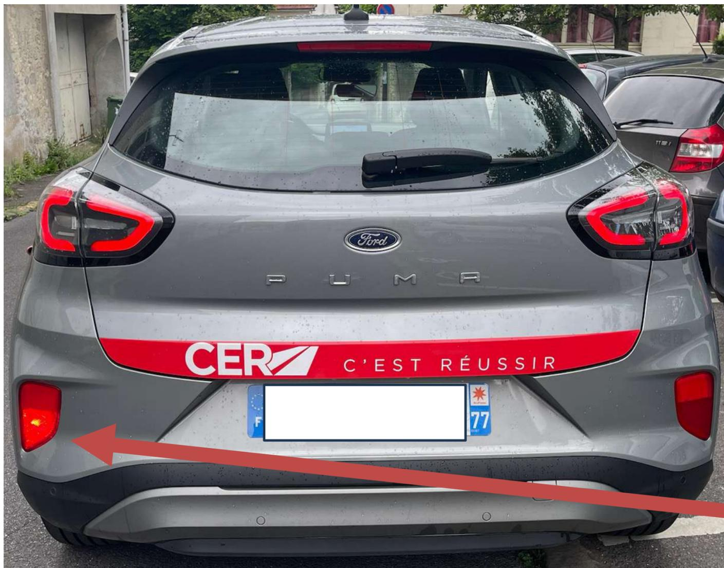
**Vérification des feux, propres, en bon état de fonctionnement et pas cassés (toute anomalie et dysfonctionnement doit être signalé).**
