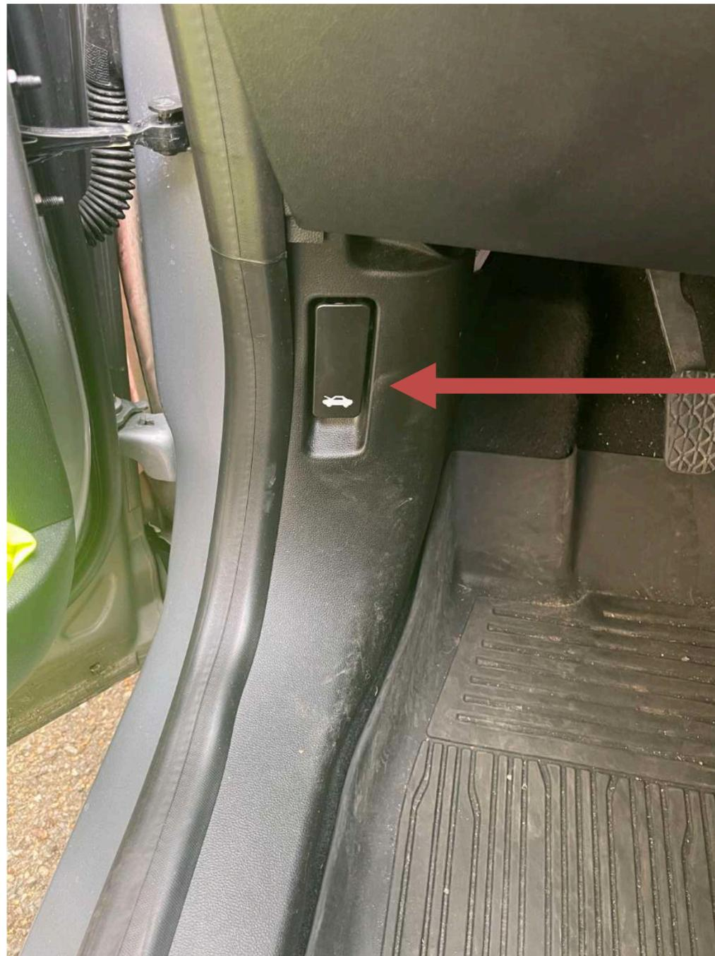
Pour ouvrir le capot du moteur, ouvrez la portière conducteur. Sur le montant de la portière se situe une languette à tirer pour déverrouiller le capot du moteur.
